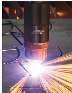
Consumibles de ATTC cumplen con normas más estrictas en la industria, inclusive de verificación espectroscópica e inspección con microvisión de las dimensiones críticas. Los sistemas de medición son capaces de detectar variaciones de hasta 0.0005".
